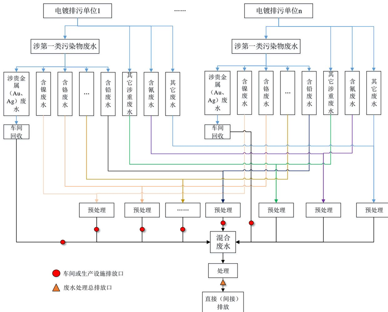
图A.2 专门处理电镀废水的集中式污水处理厂污染物排放口位置
