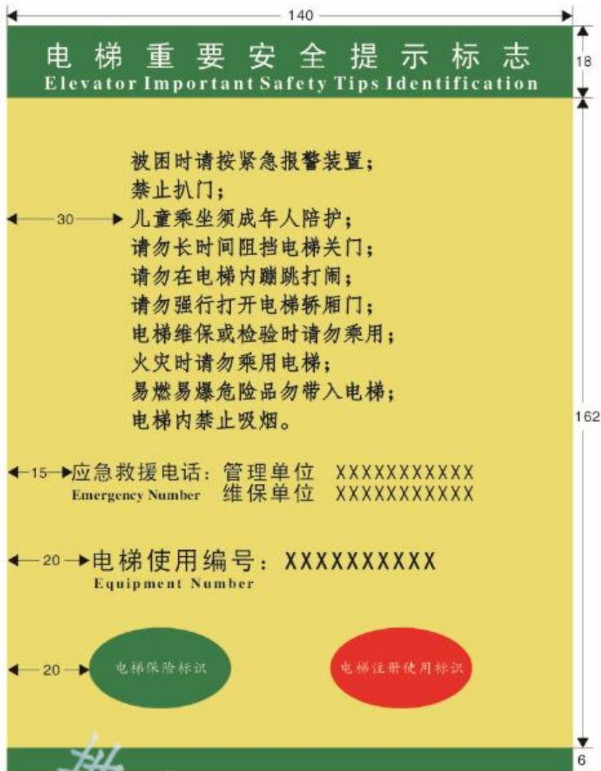
图B.7 载人（货）电梯重要安全提示标志尺寸
