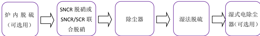
图 2 超低排放工艺流程 2 (循环流化床锅炉)
