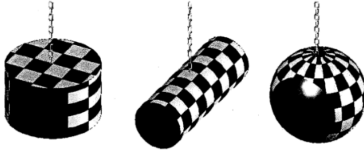
图 A.2 标出冲击区域的硬摆锤示例
