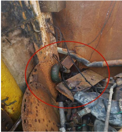
图 7：左舷燃油舱透气管
