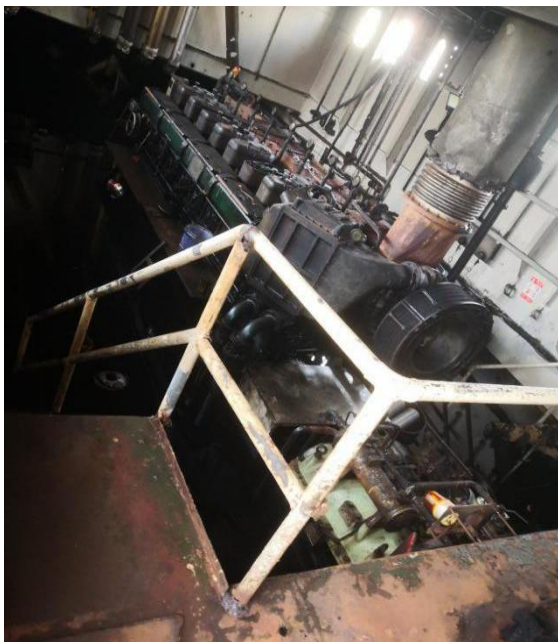
图 2：泥泵动力柴油机
