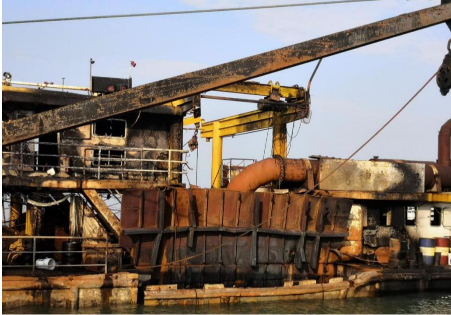
图 5：左舷燃油舱爆炸后顶板状态
