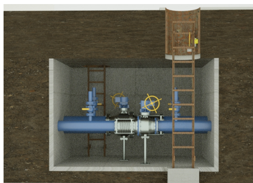
图 1 事发燃气闸井结构正视图 图 2 事发燃气闸井结构俯视图
