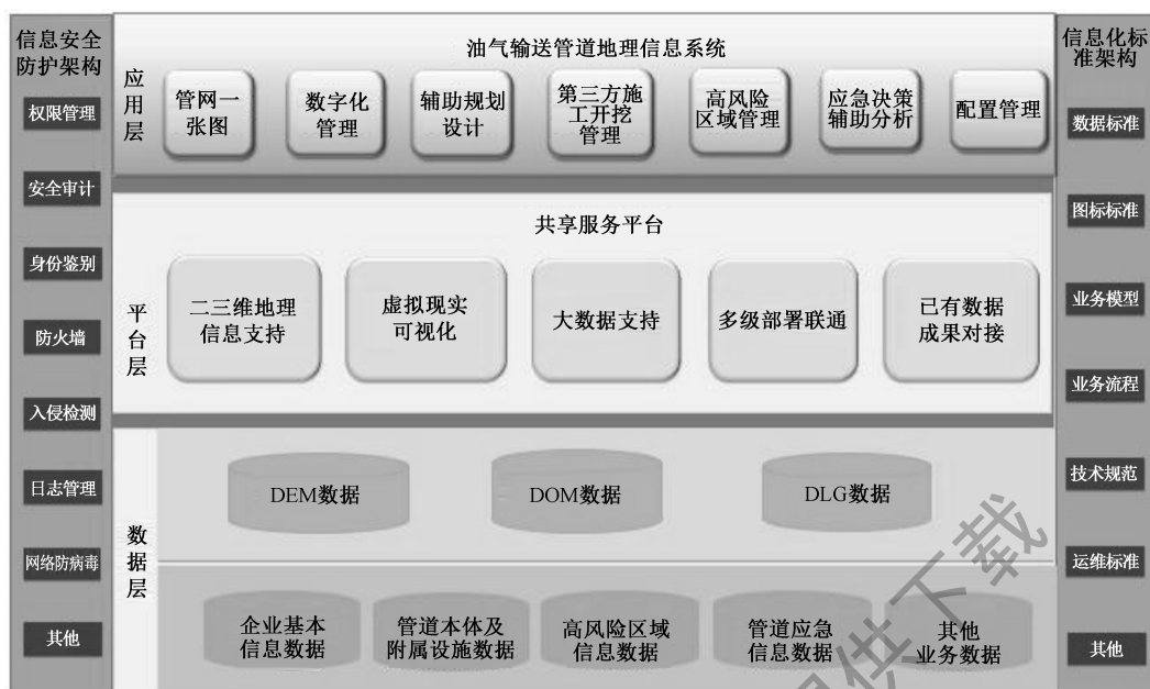
图 1 管道信息系统技术结构
