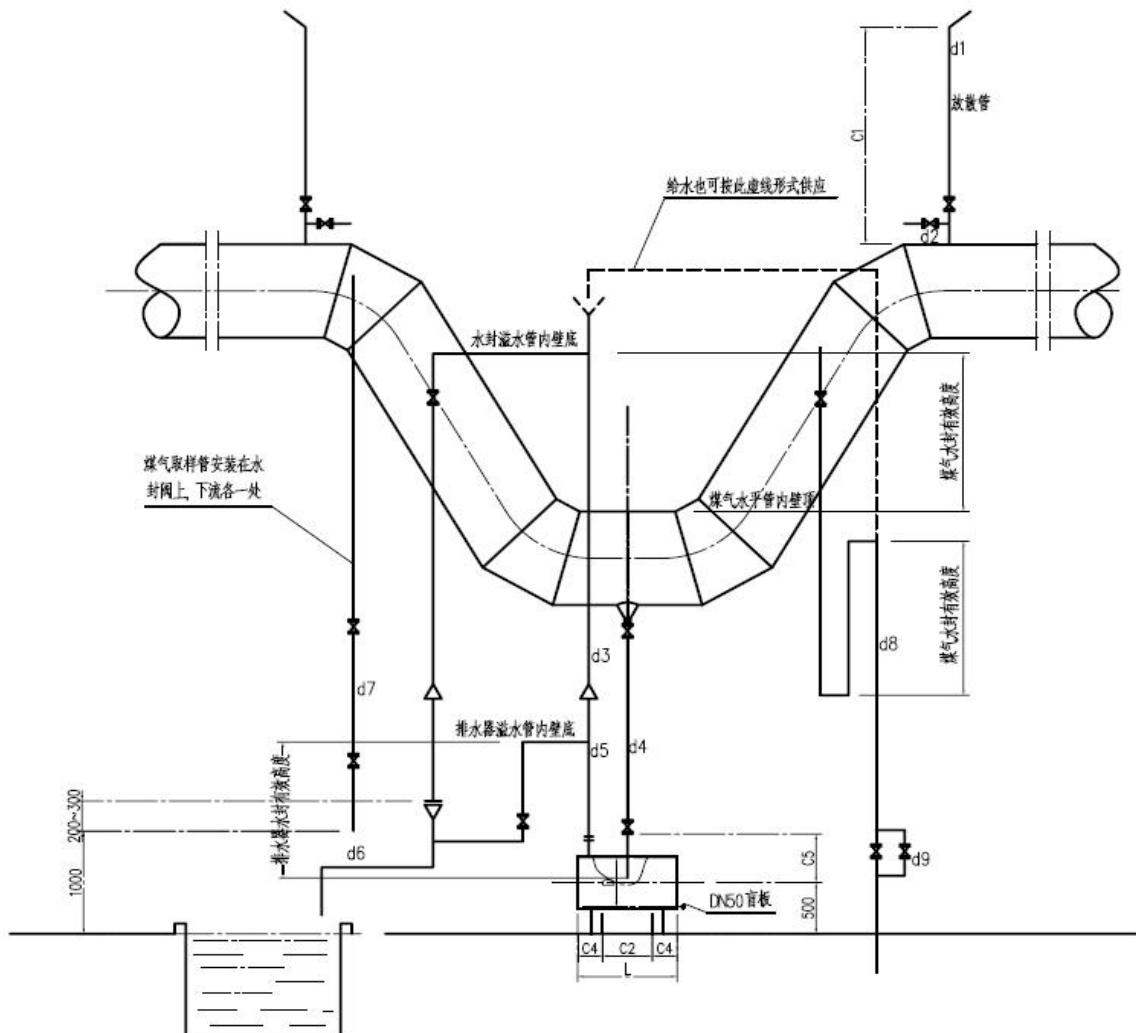
图 A.1 煤气水封管道及附属设备
