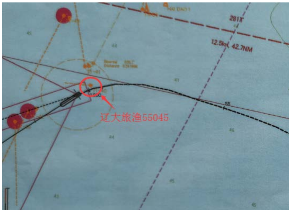
图 4：“MOUNT FABER”轮 ECDIS 显示的 1159 时航行轨迹 1200 时左右，船位： 38^{\circ}37'.4N/120^{\circ}50'.0E ，船艏向 236^{\circ} ， 航速 10.4 节，三副发现“辽大旅渔 55045”轮在右后方约 0.1—0.2 海里处倾覆，渔网挂住了本船船艏部并有拖拽迹象（如图 5 所 示），立即报告船长。
