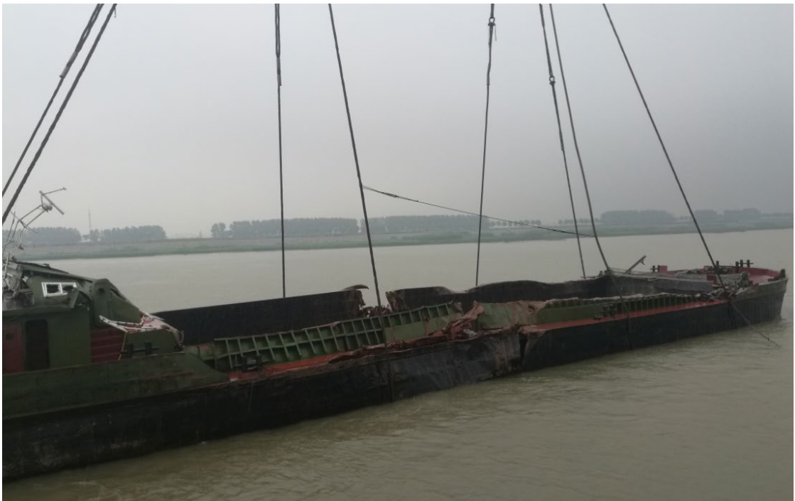
图 17：“Z”轮打捞出水后船体中前部照片
