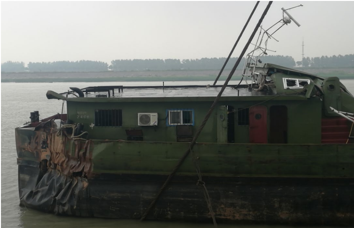
图 20：“Z”轮船尾受损情况
