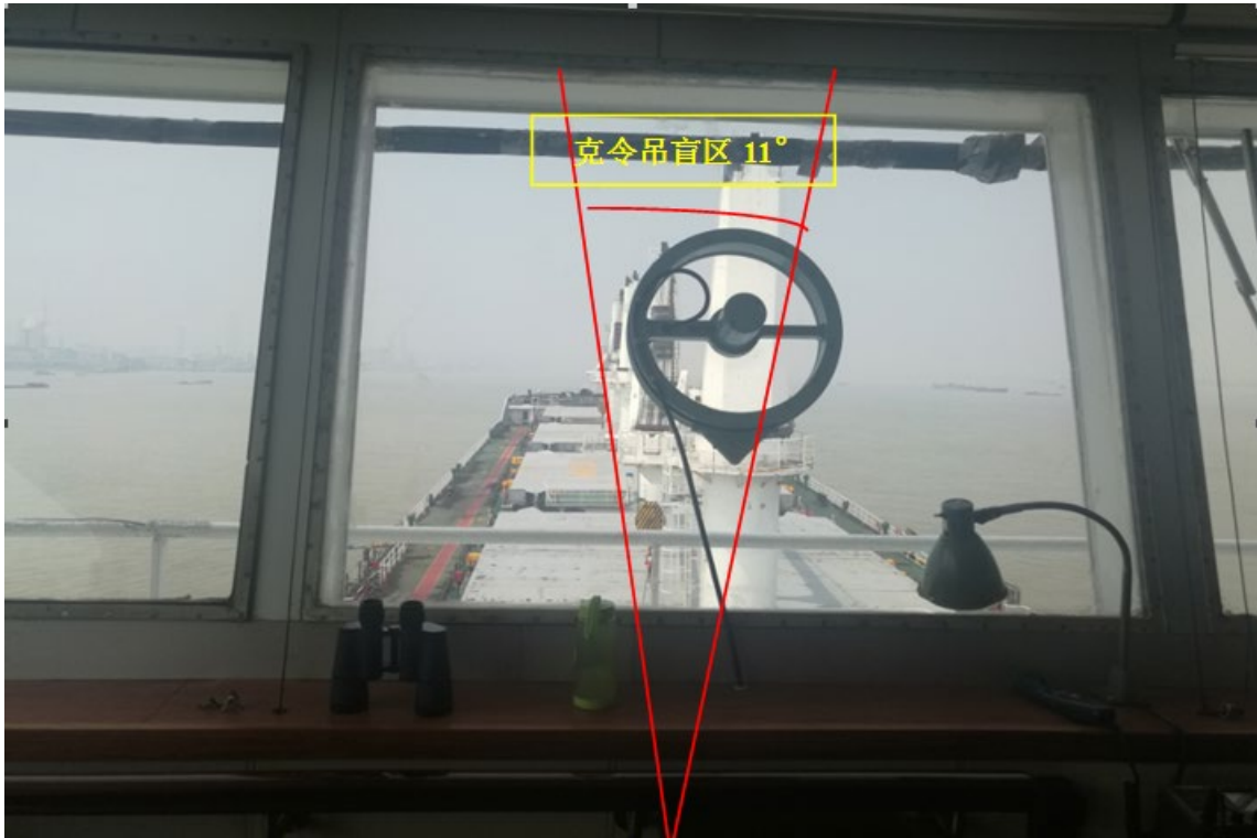
图 11：“X”轮驾驶台左雷达处的了望盲区情况
