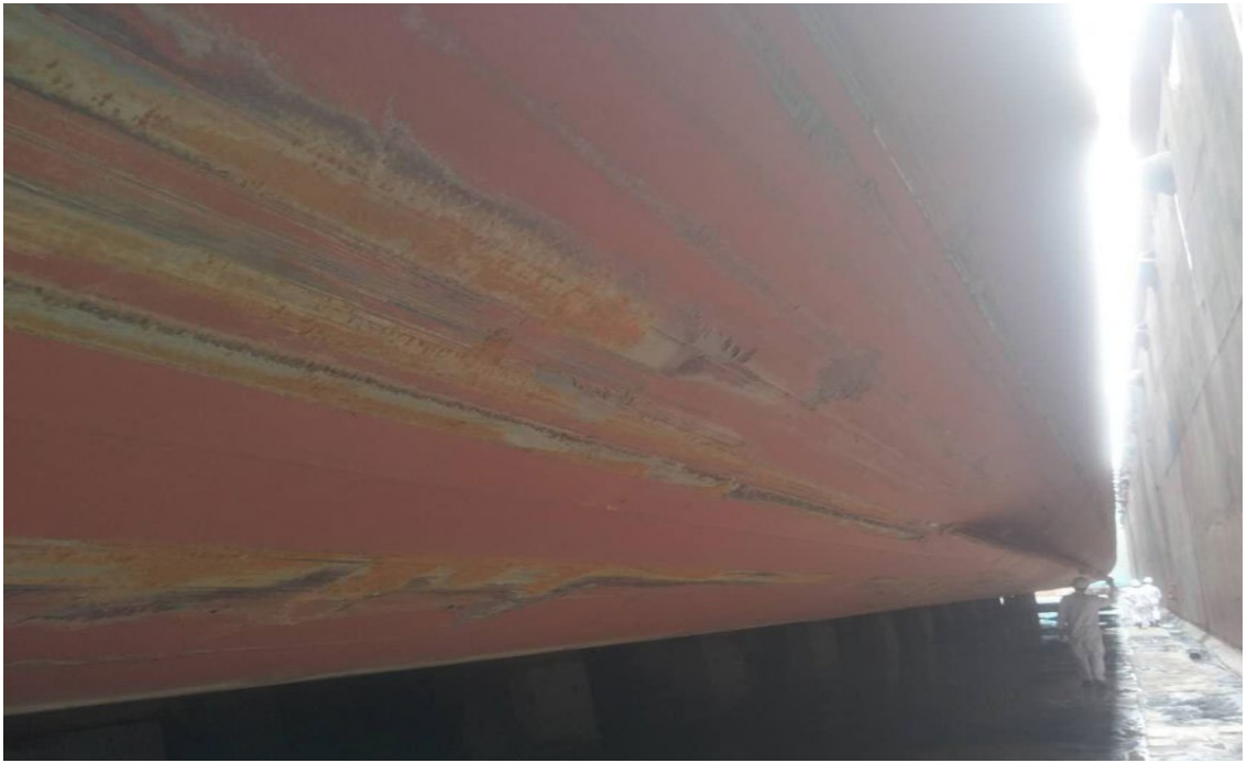
图 19：“X”轮船底左侧擦痕情况
