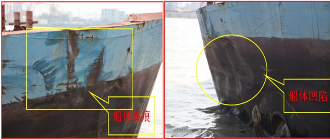
图4：“宁高鹏666”轮船体勘验
