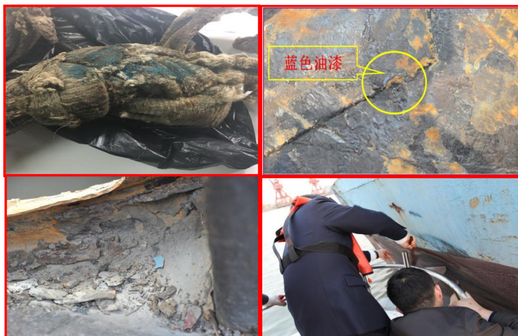
图6：“金虹18”轮和“宁高鹏666”轮油漆取样
