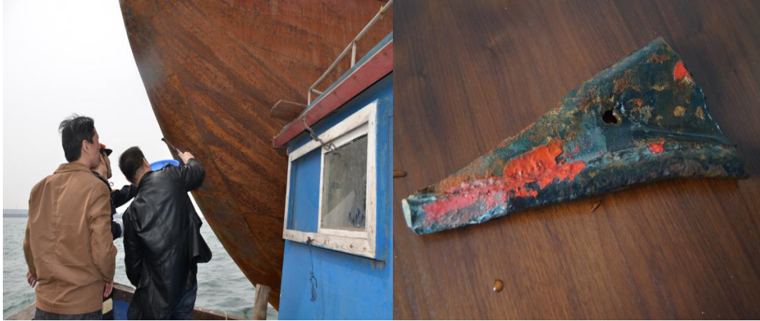
图 10：“三水 805”轮球鼻艏以及“浙三渔 00046”轮钢板油漆取样 2.油漆鉴定结论。
