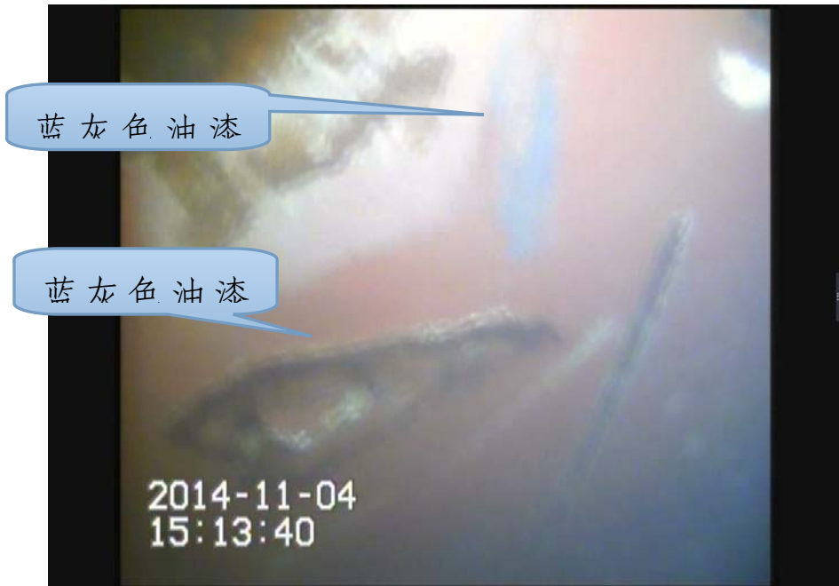
图11：“SILVER PHOENIX”轮球鼻艏左侧水下探摸视频截屏
