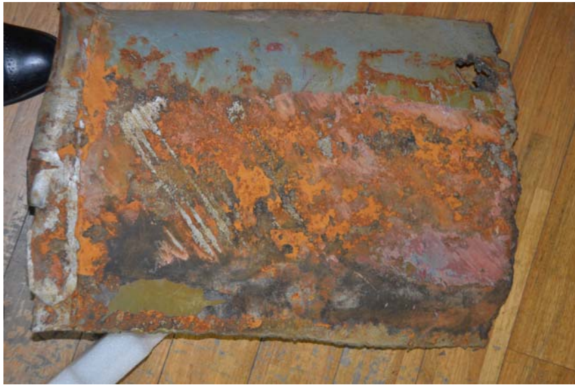
图 14：“浙嵎渔 05885”轮沉船破口处割取的船体钢板
