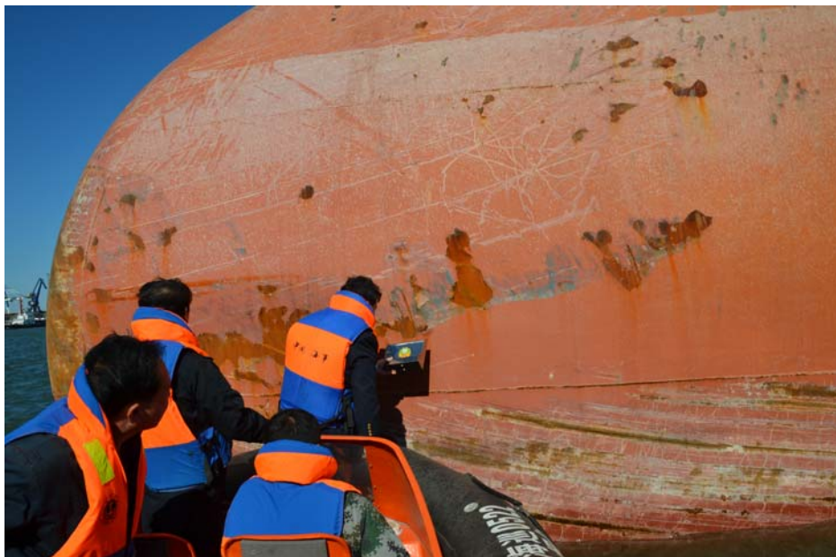
图 13: “SILVER PHOENIX”轮球鼻艏左侧油漆取样
