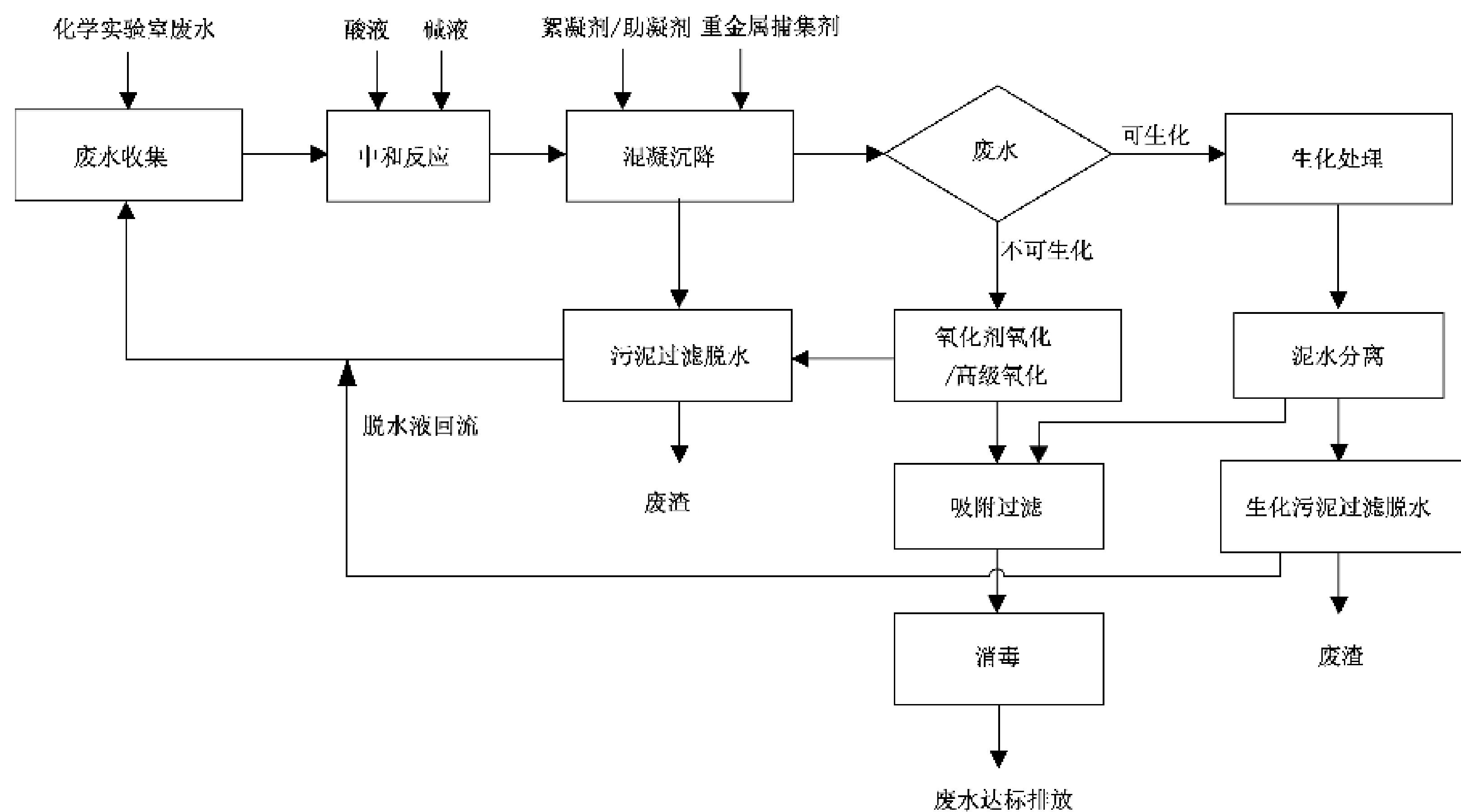
图 1 化学实验室废水处理工艺流程
